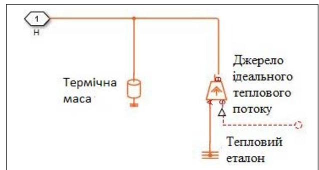
Рис. 3. Модель теплового порту
